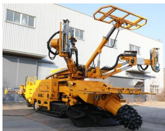
四臂掘锚一体机
