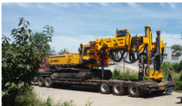
履带双臂隧道锚杆台车
