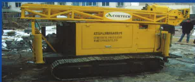
YDX-3L型钻机—孔深0-1800米 角度0°-90°
