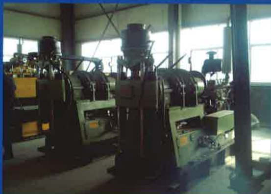
XY-6型钻机—孔深0-3000米 角度60°-90°
